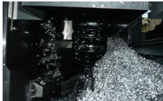
공작기계 사용시 발생하는 칩이 쌓이지 않는 타원형 디자인의 e체인 RX-tube
