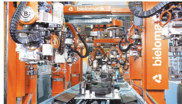
생산라인에서 다차원적인 이동이 가능한 easy triflex® e체인
