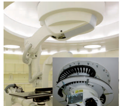
천정 부착형 X-ray 로봇에 적용된 twisterchain® 과 chainflex® 케이블
