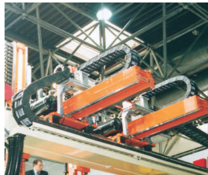
빠른 움직임과 많은 사이클 횟수를 위해 다양한 E4 e체인을 사용한 갠트리형 공작 기계
