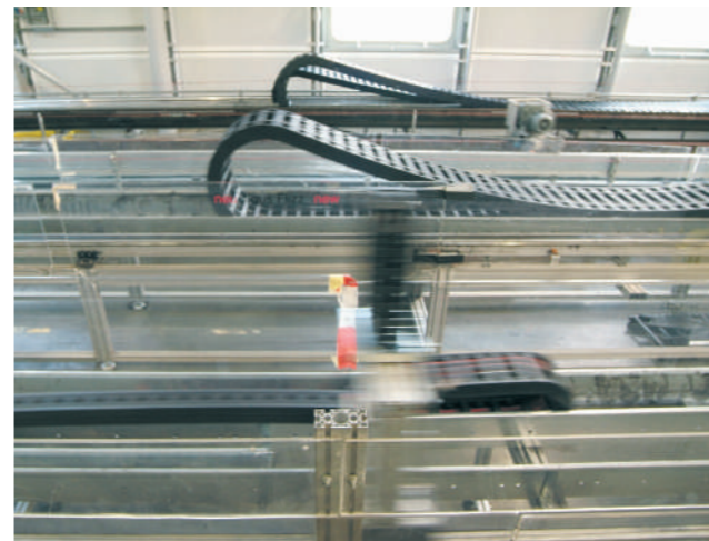
10m/s 이상의 압축 인장 속도 및 200m/s² 이상의 가속도 시험
